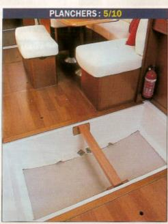
Les planchers du carré cachent plus de 900 litres de rangement, mais les panneaux de CP sont lourds (épaisseur: 20 mm) et ne se bloquent pas. Les fonds, en partie contremoulés, sont peints et peuvent se laver au jet, l'eau s'écoulant vers la pompe de cale par des rigoles.
