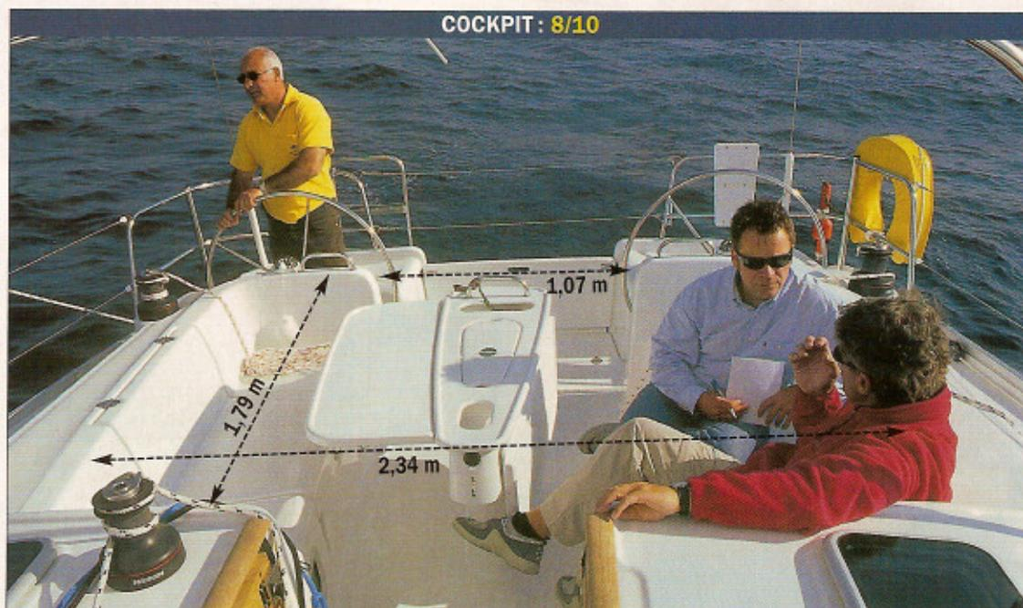
**Sur ce voilier de vacances**, accastillage et espace réservé à la manœuvre sont limités. Les deux postes de barre, sécurisants, sont ergonomiques. Le reste du cockpit est un salon de pont avec de bons points d'appui. Le deuxième winch du rouf est hélas en option.
